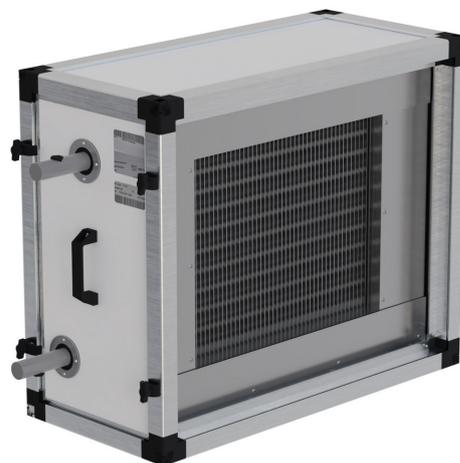
КПД рекуперации доходит до 50%. Проходное сечение теплообменников заполнено алюминиевыми пластинами через которые в шахматном порядке проходят медные трубки. Стальные коллекторы имеют резьбовые соединения для надёжного и герметичного соединения с контуром и выведены за боковую панель со стороны обслуживания. Вытяжная часть рекуператора оснащена поддоном и каплеуловителем для сбора и удаления конденсата.
