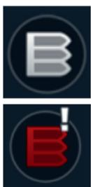
Отображение фильтрующей секции на мнемосхеме позволяет визуально контролировать состояние фильтра. Элемент является кликабельным — при нажатии открывается экран «ФИЛЬТР», на котором отображаются текущий статус фильтра и аварийное сообщение в случае его загрязнения. Если функция «Наработка вентилятора» отключена, параметры наработки до индикации засорения и соответствующая уставка отображаться не будут.
