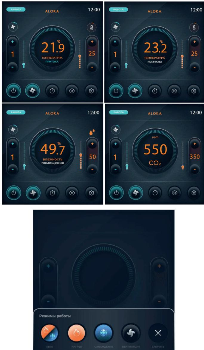
После нажатия на кнопку смены режима работы установки в нижней части экрана отображаются иконки доступных режимов. Для выбора нужного режима необходимо нажать соответствующую иконку. Выход из меню режимов осуществляется однократным нажатием кнопки закрытия.
