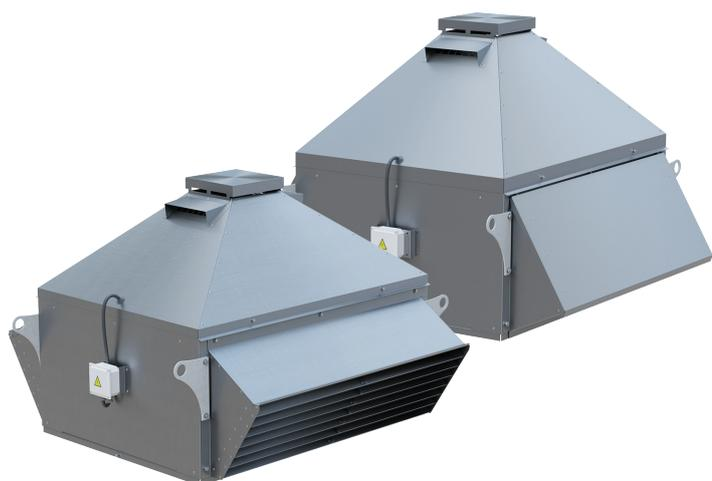
Вентиляторы крышные радиальные общепромышленного назначения с выходом потока воздуха в стороны РОКС-ВКРС и вверх РОКС-ВКРФ представляют собой крышные радиальные вентиляторы низкого давления, одностороннего всасывания, с рабочими лопатками загнутыми назад, устанавливаемые на кровле здания на стаканы монтажные типа СОМ.
